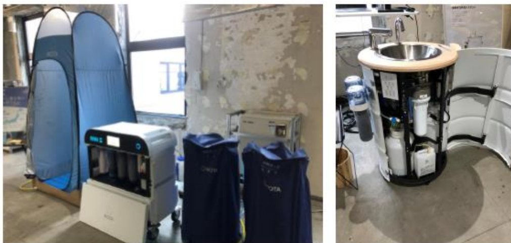
(左) WOTA BOX、左はシャワールーム、黒いカバーを被った右の2つは、原水タンクと排水んじゅすいタンク、(右) WOSH、いずれもWOTA株式会社内の展示から (酒井撮影)
