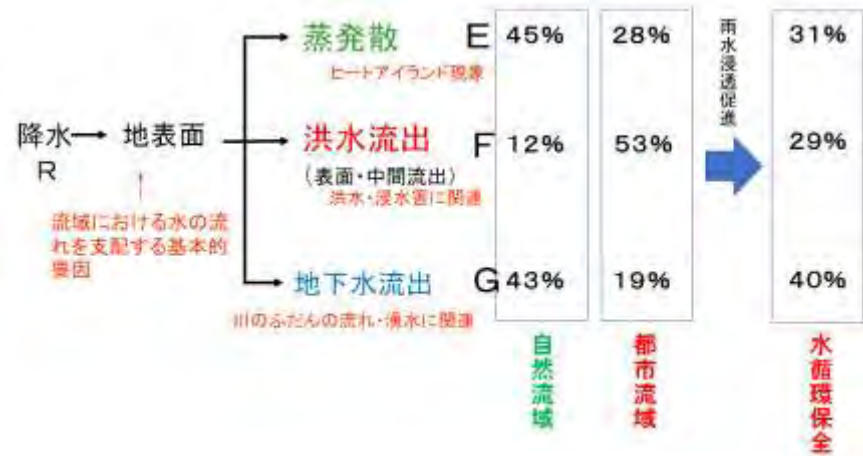
図－9 水循環保全システムによる水循環不良の改善 八王子ニュータウン：（雨水貯留浸透技術協会資料より）
